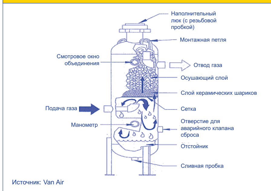
Рис. 1: Схема резервуара сиккативного осушителя
