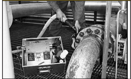
Рис. 2: Измерение утечек с использованием пробоотборника большого объема
