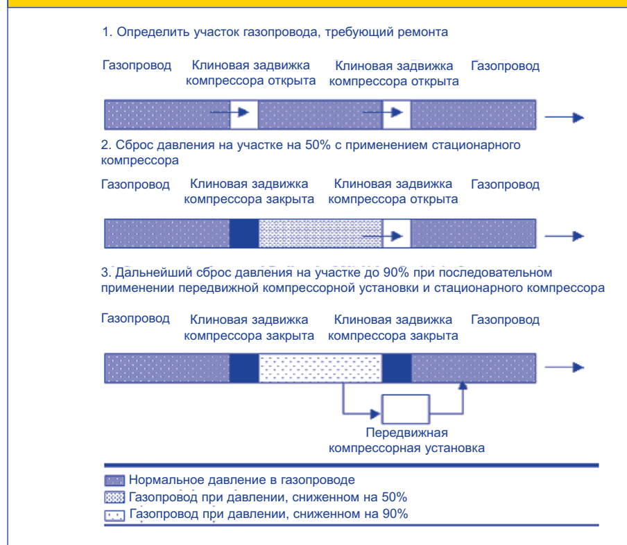
Рис. 2: Последовательность действий для сброса давления
